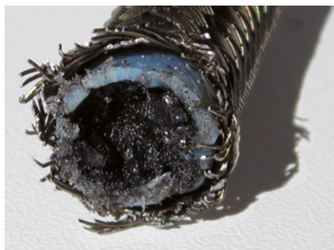
Конкурирующий продукт — маслоподающая трубка закупорена отложениями Competitive product – Feed pipes clogged up with deposits
