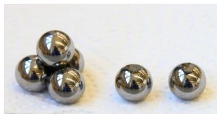
Иллюстрация 8. Испытательные шарики после сваривания
